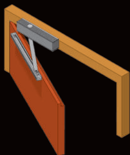
Côté paumelles, corps sur dormant
